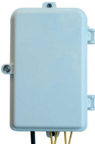
Die Box dient als Kundenanschlussbox für bis zu 4 Drop-Kabel. Die Ablage eines Splitters ist ebenso möglich wie die Montage von bis zu 4 SC-Kupplungen. Die Box ist für die Wandmontage geeignet und bietet durch UV-Beständigkeit, wasserdichte Einführungen und IP65-Konformität soliden Schutz vor Umwelteinflüssen.
